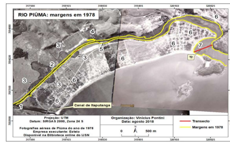
Mapa 18. Rio Piúma em 1978. 1) novo início do canal reapetado; 2) trechos outros sinuosos agora retilizados; 3) meandros abandonados; 4) identificação do canal; 5) banco arenoso; 6) avanço da urbanização; 7) assoreamento do estuário.
